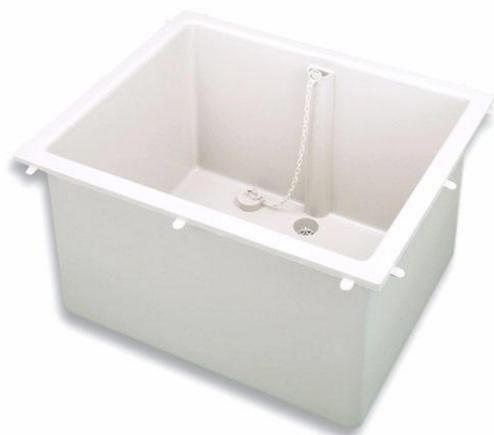
Le vasche e vaschette in polipropilene anticorrosione sono realizzate in un unico pezzo senza giunzioni con bordi e spigoli arrotondati ed antinfortunistici a mezzo di stampaggio ad iniezione e sono fornite complete di griglia di raccolta inferiore e di scarico filettato.
